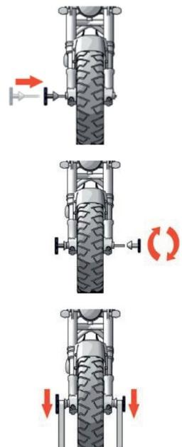
*Pendant le serrage, assurez-vous du bon centrage des cônes sur l'axe creux de la roue respective.*
