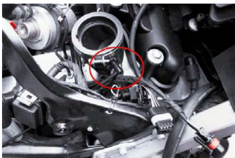
Luftfilterkasten und Drosselklappe entfernt. Unterdruck hergestellt am
