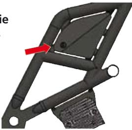
2. Finden Sie den Unterdruckstopfen am Boden des Luftfilters.
