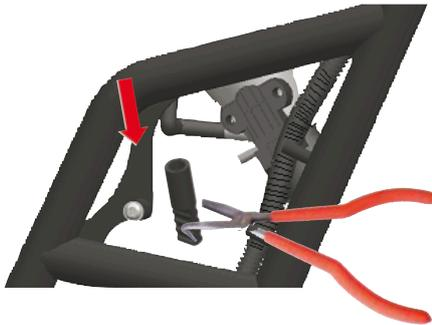
4. Stecken Sie den schwarzen Unterdruckschlauch in den 8mm Unterdruckfilter (SA-0103).
