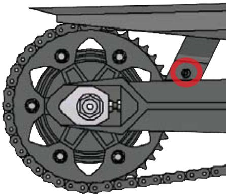
1. Entfernen Sie die Befestigungsschraube des hinteren Kettenschutzes mit einem T30 Torx Schlüssel. Es ist nicht notwendig den Kettenschutz zu entfernen
