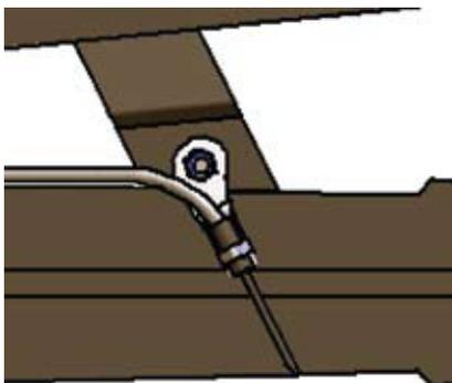
3. Sichern Sie die Spendereinheit mit Hilfe der Schlauchschelle an der Spenderplatte. Die Schlauchschelle dafür um die schwarze Plastikummantelung herumführen.
