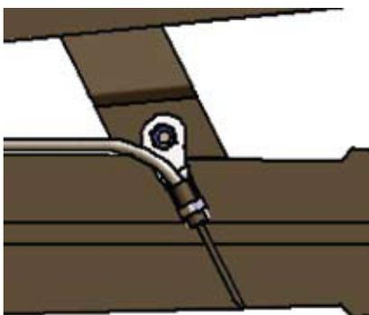
3. Düseneinheit mit Hilfe der Schlauchschelle an der Spenderplatte sichern. Schlauchschelle dafür um die schwarze Plastikummantelung herumführen.
